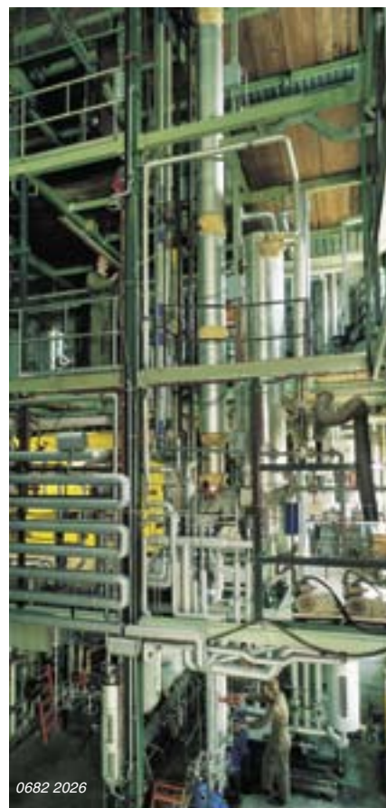
Многоцелевая пилотная установка для разделения смесей ректификацией с использованием различных типов регулярных насадок Зульцер
