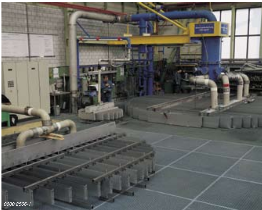
Испытания распределителей на стенде фирмы Зульцер Хемтех
